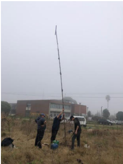
EXCAVACIÓN CON PALA AMERICANA EN CATEO 1
